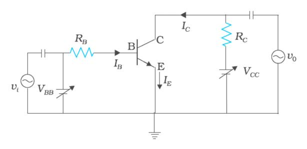
$$V_{CC} = V_{CE} + I_C R_L$$
